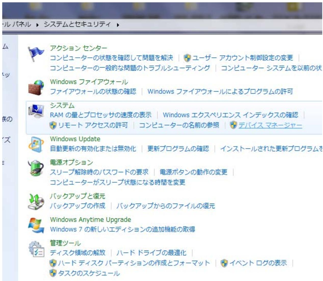
④「デバイスマネージャー」上の、ユニバーサル シリアル バス コントローラー配下のデバイスで、「不明なデバイス」を右クリックします（※写真では既に“Cypress EZ-USB Example Device”になっていますが、ドライバーインストール前は不明のデバイスになっています）。
