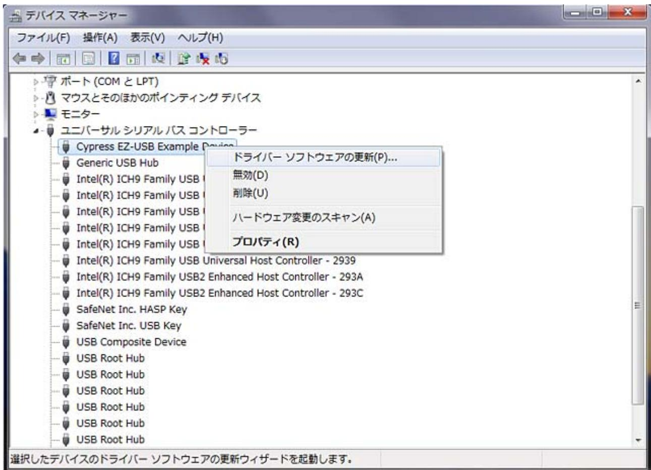
⑤ 「コンピューターを参照してドライバーソフトウェアを検索します」を選択します。
