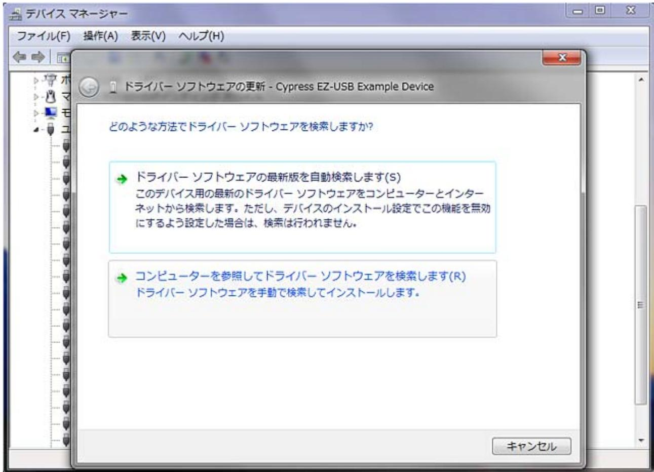
⑥「参照」ボタンを押すと「フォルダーの参照」ダイアログが現れますので、コンピュータ上に保存したドライバーソフトウェア（CyUSB.sys , CyUSB.inf）のあるフォルダを指定して「OK」ボタンを押します。
