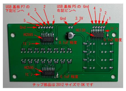
上図のように IC 類を実装し、USB DUAL AUDIO 基板と接続します。 LED は、抵抗側がアノードになります。
